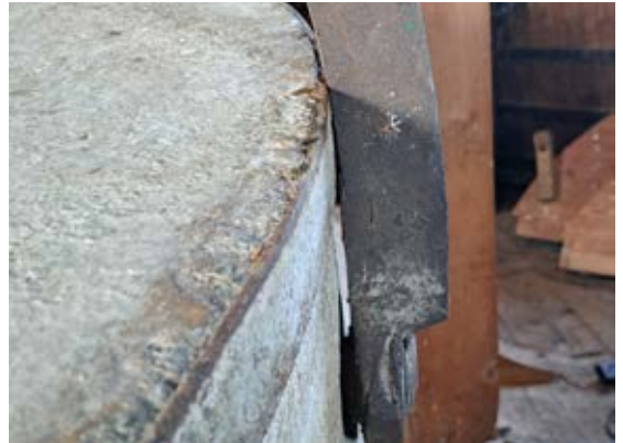
Beugel klemt tegen de steenrand
